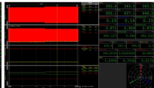
某型号光伏逆变器电压/无功控制能力检测结果
